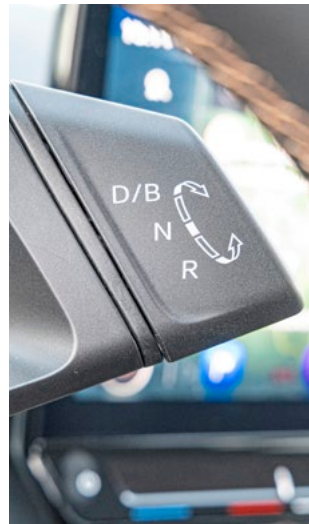
Der Kippschalter wechselt die Fahrstufe. Die B-Stufe aktiviert den Einpedalmodus. Lenkradtasten für die Fahrmodi
