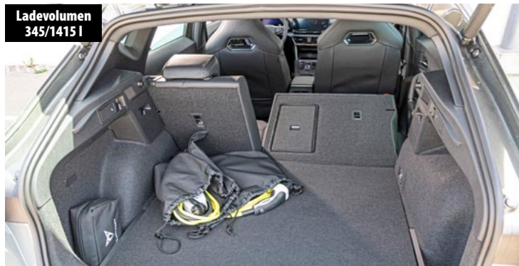
BATTERIEPAKET und Tank nehmen den Unterboden des Kofferraums komplett ein. Die Ladekabel liegen stets im Weg
