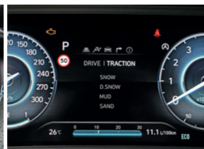
Einstellbar: Die Traktionskontrolle lässt sich an die Fahrbahnbedingungen anpassen
