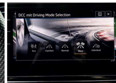
Das adaptive Fahrwerk erlaubt vielfältige Einstellungsmöglichkeiten
