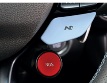
NGS: N Grin Shift. Per Tastendruck mehr Drehmoment für 20 Sekunden
