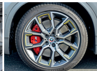
Die M-Sportbremse mit roten Sätteln ist serienmäßig und bietet ein gutes Pedalgefühl
