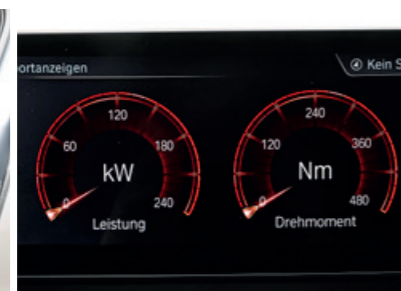
Sportanzeigen informieren den Fahrer über Leistung und Drehmoment
