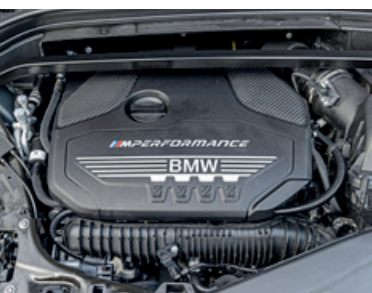
Das 306 PS starke Aggregat gefällt mit dem höchsten Drehmoment (450 Nm)
