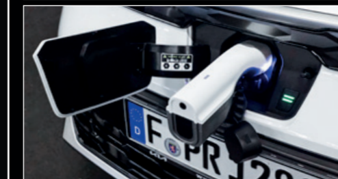
Spezialstecker für die Stromabgabe, etwa an E-Bike-Akkus
