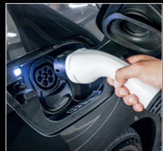
Je nach Stromquelle sind bis zu 120 Kilowatt Ladeleistung möglich
