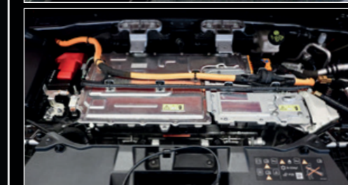
Fremderregte Synchronmaschine ohne seltene Erden
