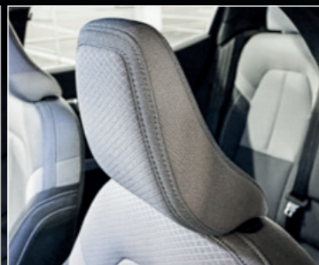
Je nach Körperstatur reichen die Kopfstützen des Polestar 2 zu weit nach vorn
