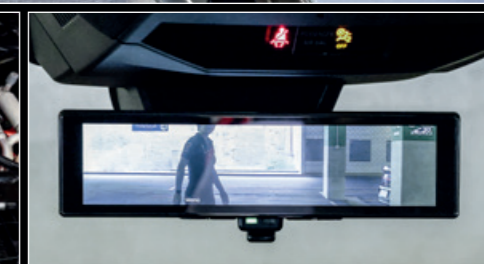
Umschaltbar: Innenspiegel mit Rückfahrkamera-Bild
