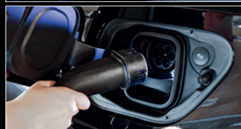
Ladedose mit Taste für manuelle Steckerentriegelung
